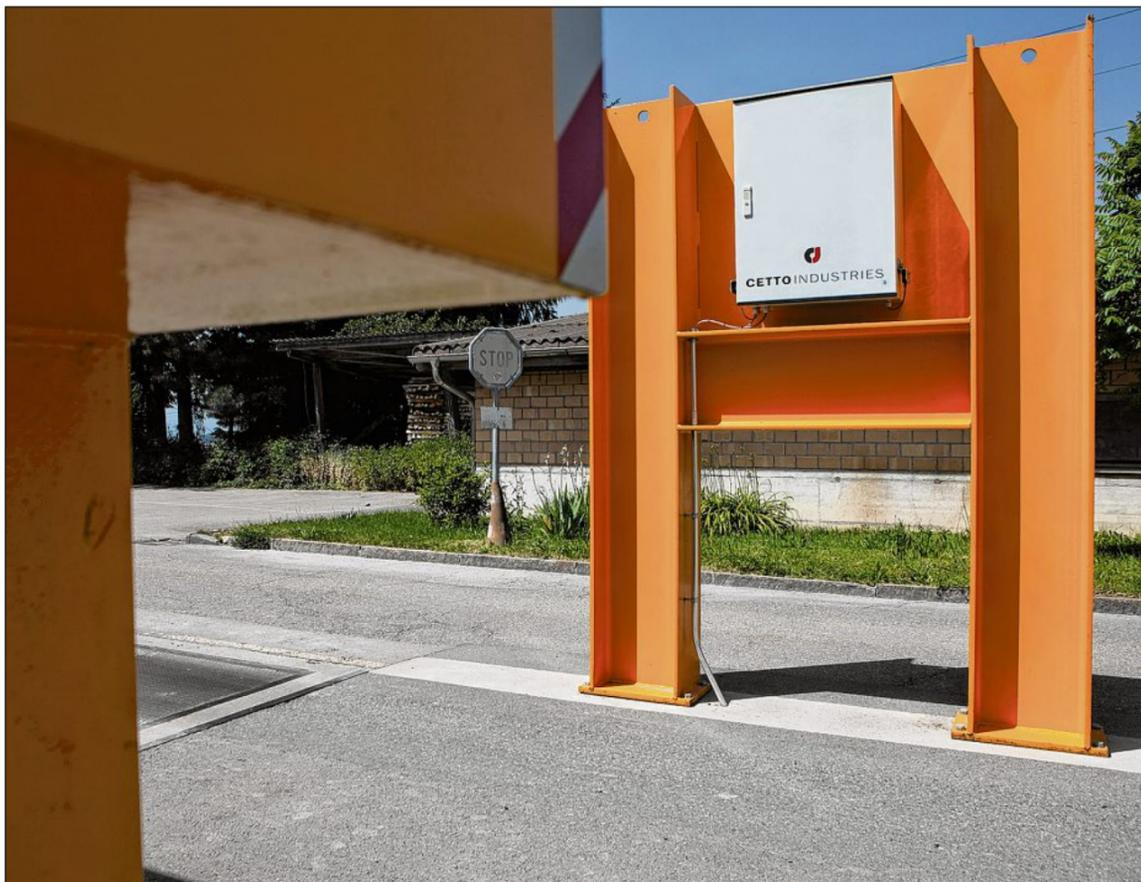
C'est grâce à ce portique de détection de la radioactivité, installé à l'entrée de la décharge de Teuftal (BE), que la vaste contamination au radium 226 de l'ancienne décharge des Fléoles a pu être identifiée. THOMAS DELLEY
